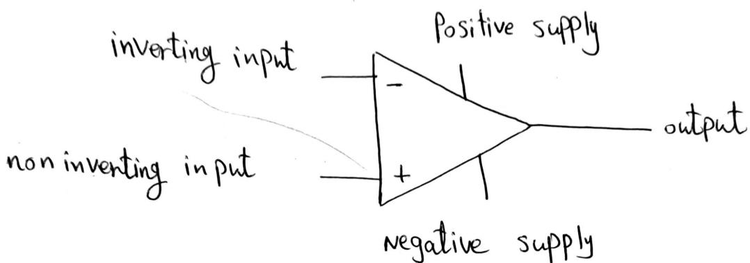
$$\text{input} \rightarrow X \rightarrow \boxed{A} \rightarrow \text{out} = X \cdot A \quad \text{فكرة عمل المكثب} \leftarrow \text{Gain}$$
