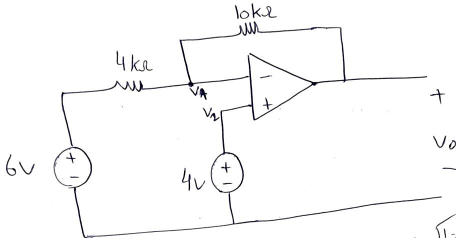
by using superposition theorem  $\therefore$  نظرية التراكب
