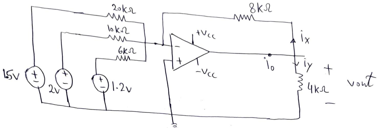
$$V_{out} = - \left( \frac{8k}{20k} \times 1.5 + \frac{8k}{10k} \times 2 + \frac{8k}{6k} \times 1.2 \right)$$
